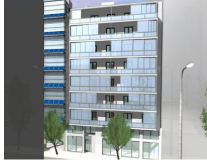
Εικόνα 2. Αποψη δικέλυφης όψης κατά τους ενδιάμεσους μήνες
