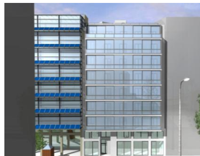
Εικόνα 1. Αποψη δικέλυφης όψης κατά τους ψυχρούς μήνες
