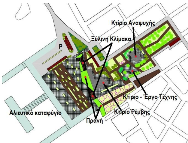
Σχήμα 3. Πρόταση Ανάπλασης της περιοχής μελέτης. Με πράσινο χρώμα τα πάρκα, οι χώροι πρασίνου και οι δασικές εκτάσεις, με καφέ οι ξύλινες επιφάνειες, με γκρι οι σκληρές επιφάνειες χαμηλής ανακλαστικότητας (άσφαλτος, πλάκες σκυροδέματος) και με κόκκινο ή άσφαλτος κόκκινου χρώματος (χαμηλής ανακλαστικότητας).
