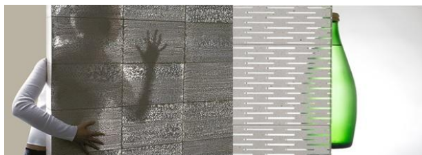
Εικόνα 3 : Φωτοδιαπερατό σκυρόδεμα α) με οπτικές ίνες και β) με ρητίνες α) www.Litracon.hu , β) www.italcementigroup.com
